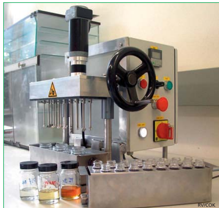
High-throughputtoestel ontwikkeld aan de KULeuven voor het simultaan roeren van 16 verschillende membraanoplossingen met hoge viscositeit en vluchtigheid.
